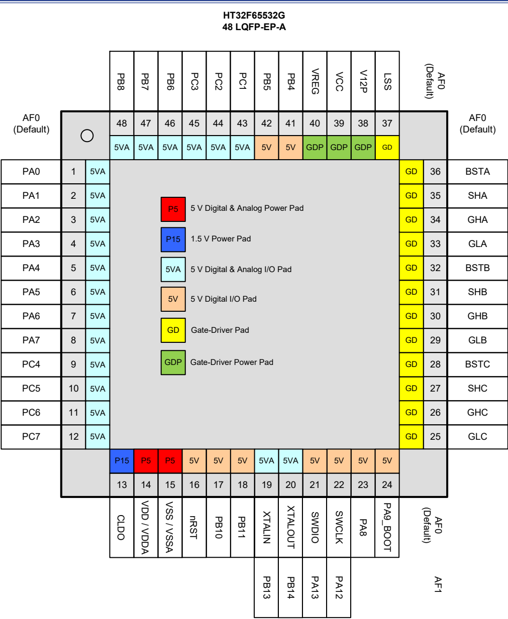
图 10. 48-pin LQFP-EP 引脚图
