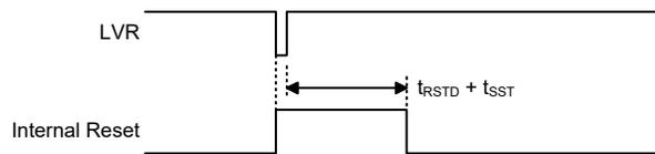
注： $t_{RSTD}$  为上电延迟时间，具体规格见系统上电时间电气特性。
