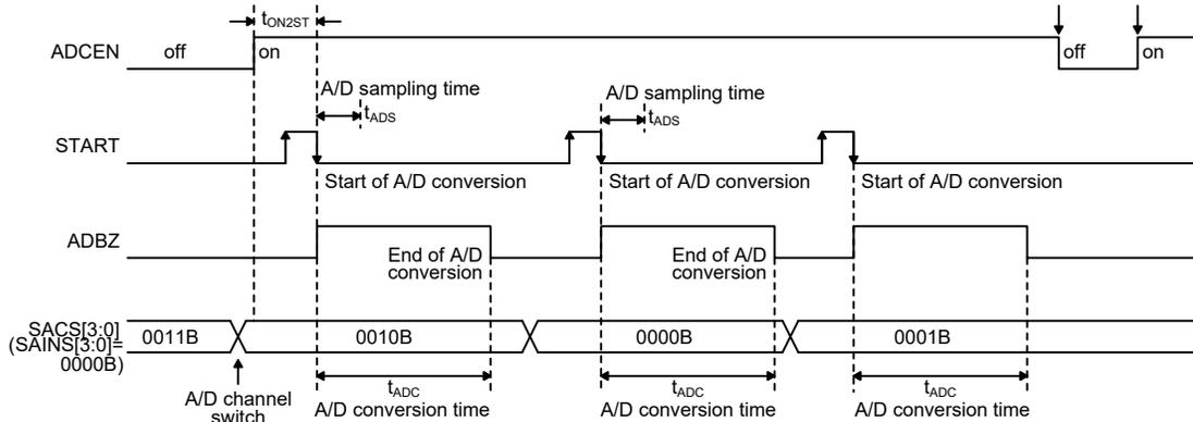
A/D 转换时序图 – 外部通道输入
