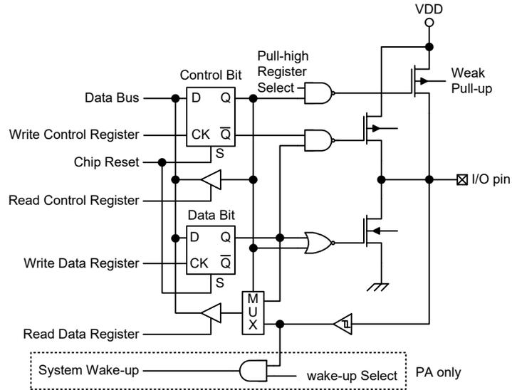
输入 / 输出端口逻辑功能结构
