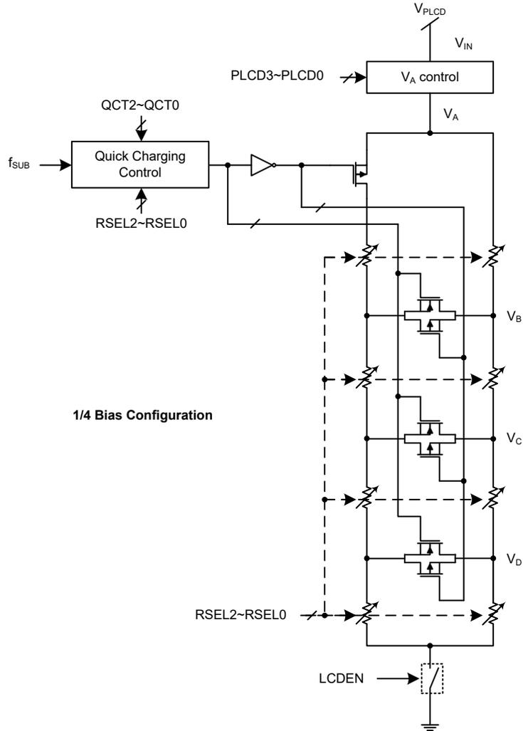
注：当 R 型 LCD 除能，直流通道将被关闭。
