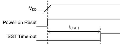
注： $t_{\text{RSTD}}$  为上电延迟时间，具体规格见系统上电时间电气特性。
