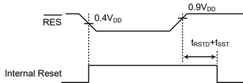
注： $t_{RSTD}$  为上电延迟时间，具体规格见系统上电时间电气特性。
