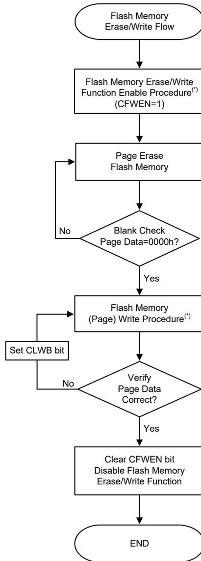
Flash 存储器擦 / 写流程图
