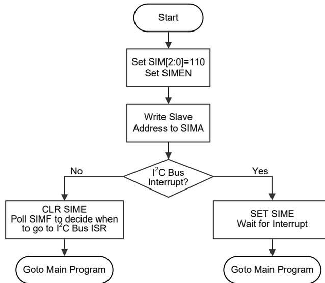
I<sup>2</sup>C 总线初始化流程图
